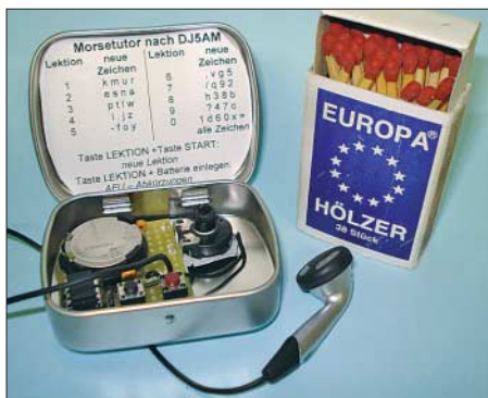
Bild 1: Morse-Tutor in der als Gehäuse dienenden Bonbondose Foto: DJ5AM
