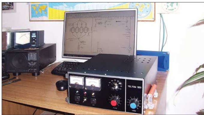
Bild 1: GU-50-Endstufe betriebsfertig auf dem Stationstisch
