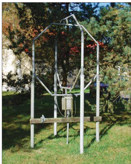
Bild 4: Vier solcher gekreuzten Rahmenantennen empfangen die reflektierten Signale aus der Ionosphäre.
