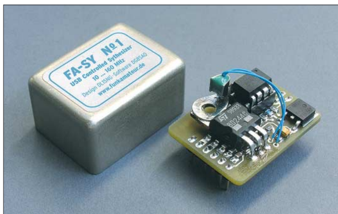
Bild 1: Ansicht des fertigen Moduls (hier Prototyp) bei geöffneter Haube; der Bausatz ist über [4] erhältlich.
