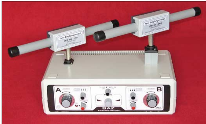
Bild 1: Auf dem BAZ-VM-A-Modul für Phasingbetrieb (in diesem Beitrag als Phasensteuerung bezeichnet) ist rechts der Aufbau für die erhöhte Antennensteckbuche zu erkennen.
