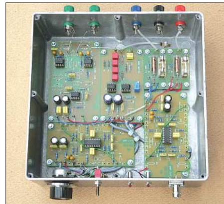
Bild 12: Messverstärker für die in Bild 11 gezeigte Spule Fotos: DG9WF
