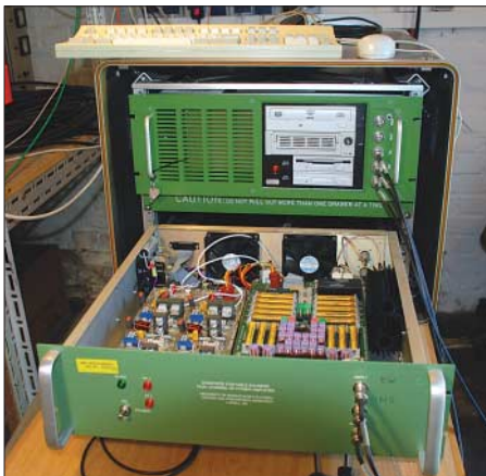
Bild 1: Die Ionosonde DPS besteht aus zwei Einschüben in einem transportfähigen Gehäuse. Der obere Einschub enthält einen Daten- und einen Steuercomputer, die Signal-erzeugung und den Empfänger. Im unteren Einschub befinden sich die beiden Endstufen und Filter zur Unterdrückung von Oberwellen.
