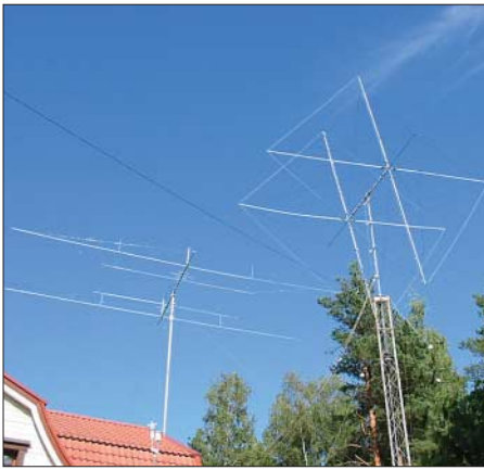
Bild 10: Vergleich der neuen Richtantenne (l.) mit der noch nicht demontierten DJ4VM-Quad im Praxistest
