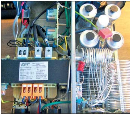
Bild 3: Blick auf die geöffnete PA; linke Kammer Netzteil und Steuerung, rechte HF-Teil
