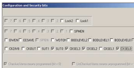
Bild 3: Einstellung der Fusebits des ATtiny 2313 in PonyProg bei 4 MHz interner Taktfrequenz Foto und Screenshots: Weinreich
