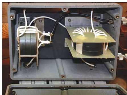
Bild 2: Baluns zur Anpassung der Sendean-tenne
